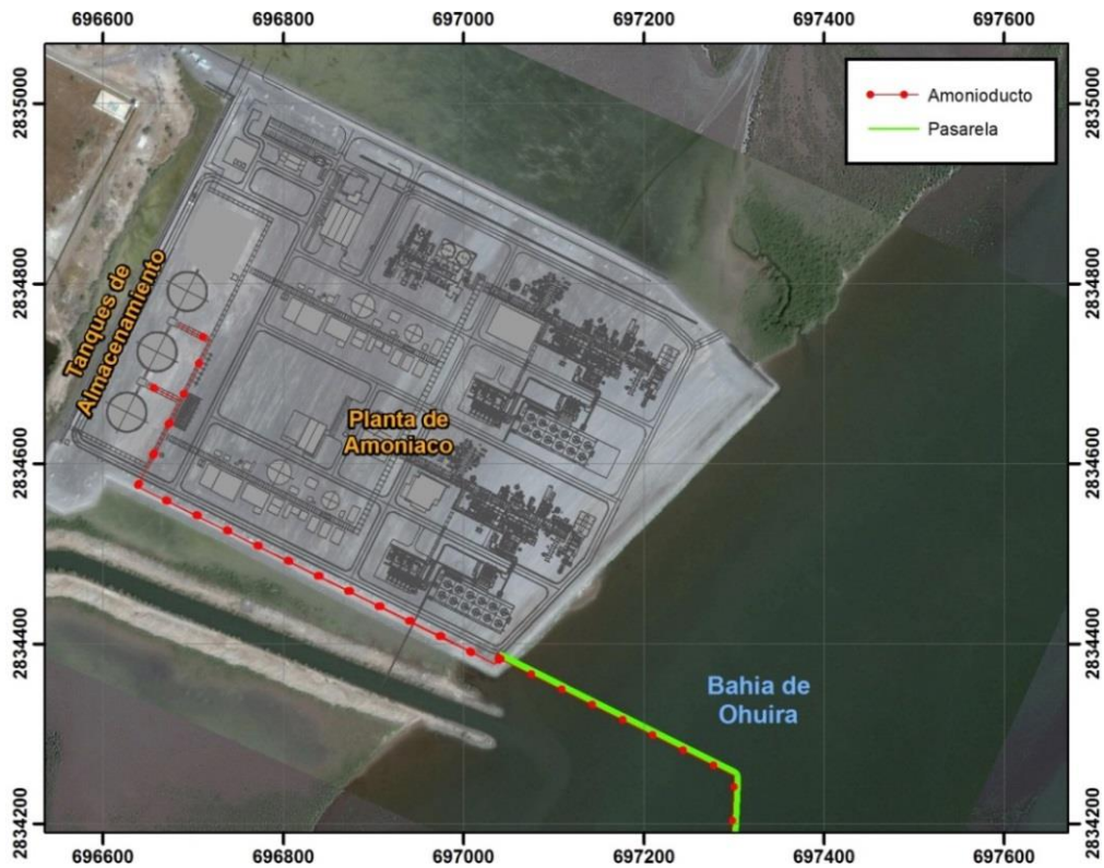
Figura 2. Detalle de la ubicación del amonioducto en los terrenos de la planta de amoníaco.
